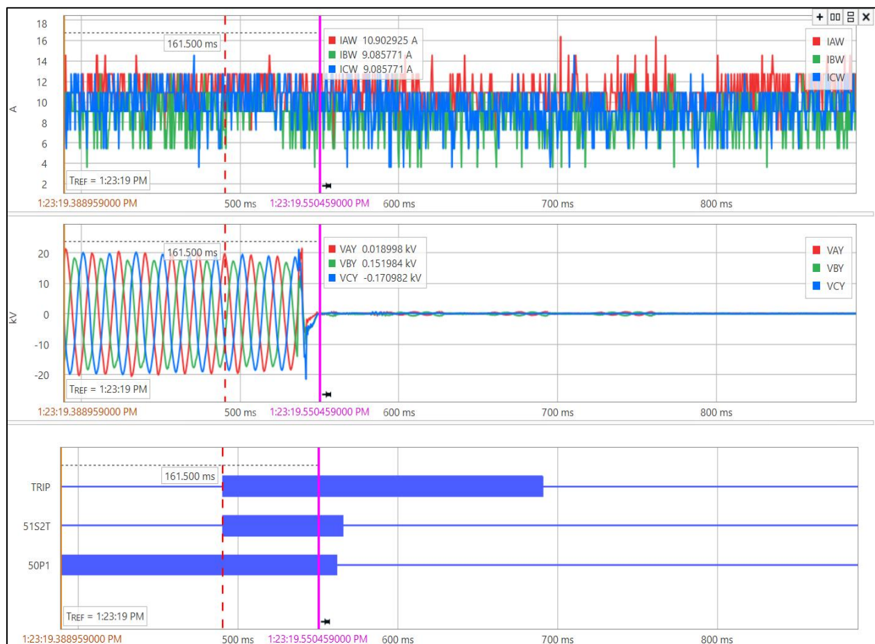
Figura 25. Registro de falla COMTRADE y señales binarias del campo de línea 138 kV San Pedro Bioenergy – SPM
